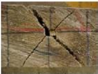
Rajaduras luego del secado por presencia de médula
