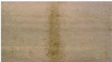
Mancha de separador por tiempo prolongado de secado
