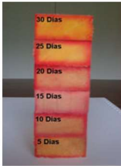
Figura 3. Secuencia de penetración de un preservante a base de sales inorgánicas de boro en madera seca de melina (CH: 26,6%).
