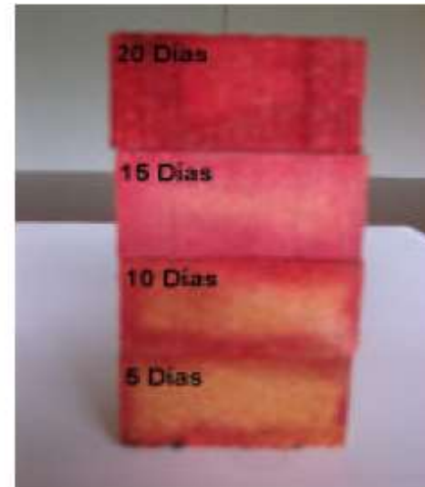
Figura 10. Secuencia de penetración de un preservante a base de sales orgánicas de boro en la madera seca de melina (CH: 130,4%).
