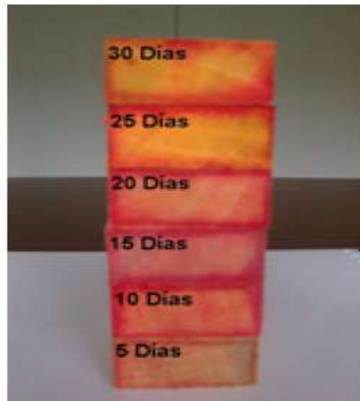
Figura 8. Secuencia de penetración de un preservante a base de sales orgánicas de boro en la madera seca de melina (CH: 26,6%).
