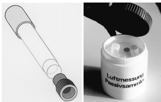
Figura 2. Esquema del colector pasivo para la determinación de dióxido de nitrógeno
