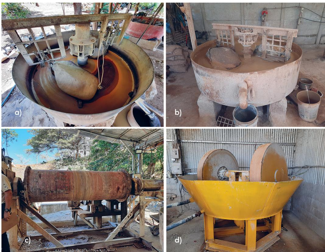
**Fotografía 1.** a) y b) Ejemplos de las rastras utilizadas también como molinos, c) el molino de bolas y d) el molino chileno
