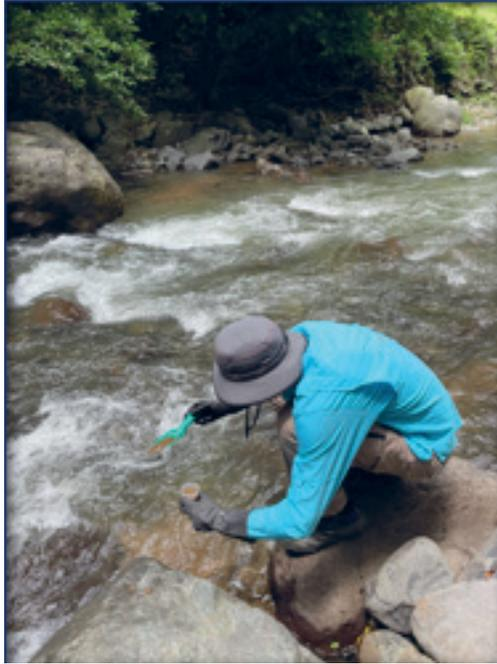
**Figura 5.** Recolección de muestra de sedimento en ríos para análisis de metales en el cantón de Abangares.
