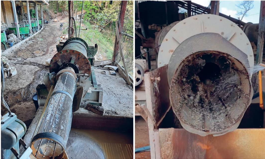
**Fotografía 3.** Detalle del sistema de lavado de material molido y de los cayucos.
