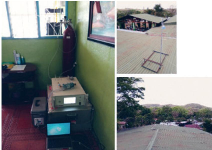
**Figura 11.** Instalación del equipo de muestreo de MEG en la Escuela San Francisco.
