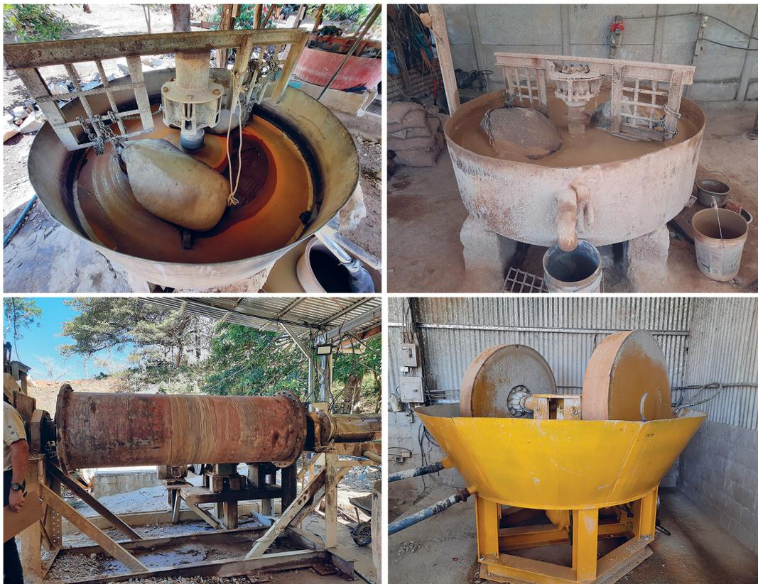
**Fotografía 2.** Ejemplos de las rastras utilizadas también como molinos (fotografías superiores), el molino de bolas (fotografía inferior izquierda) y el molino chileno (fotografía inferior derecha).
