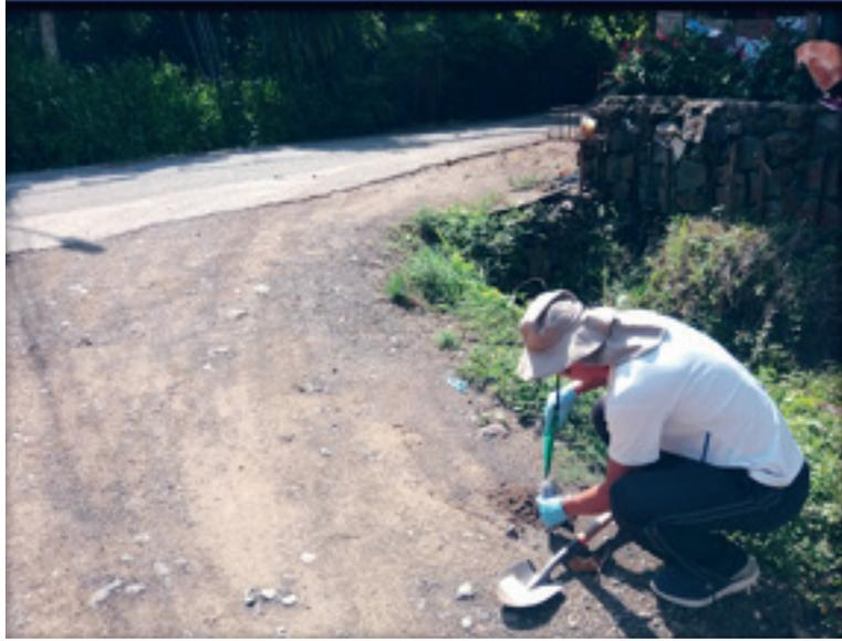
**Figura 3.** Recolección de muestra de suelo para análisis de metales en el cantón de Abangares.
