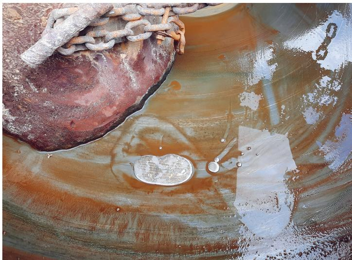
**Fotografía 4.** Detalle de la parte interna de las rastras, mostrando las piedras, parte de la estructura y el mercurio en el fondo o piso de la rastra.
