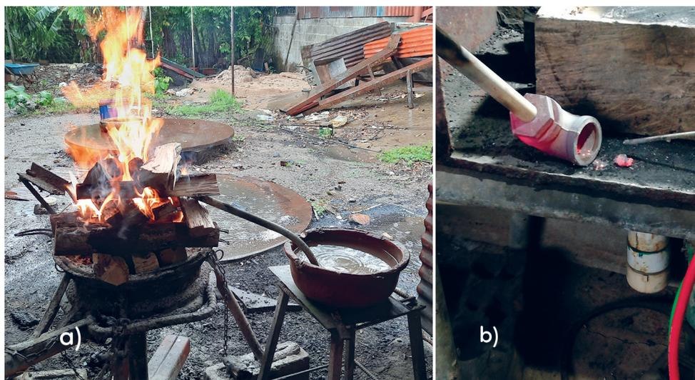
**Fotografía 5.** En a) se muestra un detalle de la retorta, mientras que en b) se nota el codo metálico con tapa.
