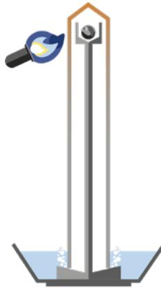
Inicialmente cuando el aire se calienta se expande y una parte del aire sale por la parte inferior en forma de burbujas.
