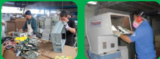
Figura 6. Fotografías del desembalaje de residuos y de la molienda de plásticos.
