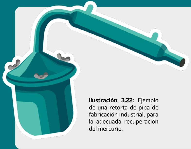
**Ilustración 3.22:** Ejemplo de una retorta de pipa de fabricación industrial, para la adecuada recuperación del mercurio.
