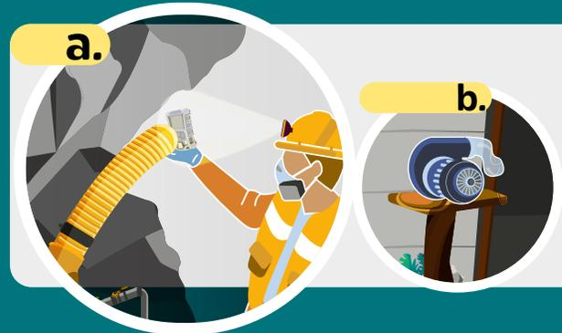
**Ilustración 3.5.** De color amarillo se muestra el conducto de ingreso de aire o ventilación a la parte interna de un túnel.
