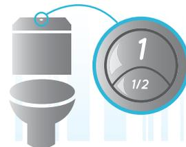
Figura 9. Ejemplo de inodoro de doble descarga.
