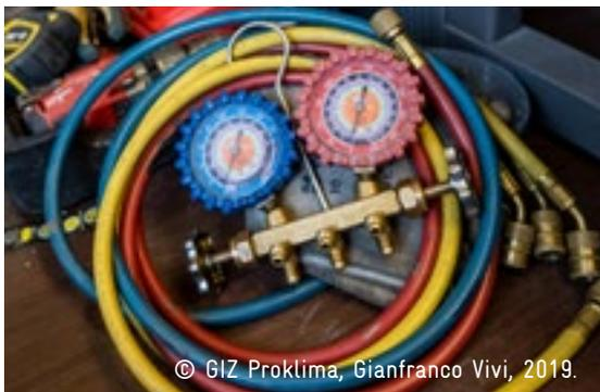
Foto 1. Herramientas necesarias para la instalación de equipo de AA con R-290.
