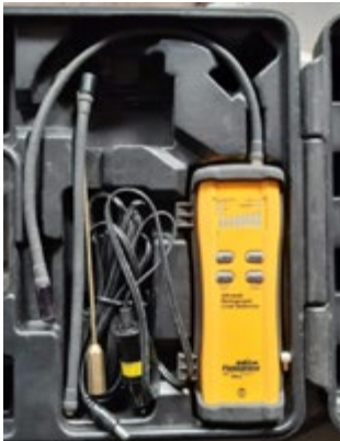
Foto 3. Componentes del detector de fugas Fieldpiece, modelo: SRL2. ©Glenn Hidalgo Mora (HIMO), 2020
