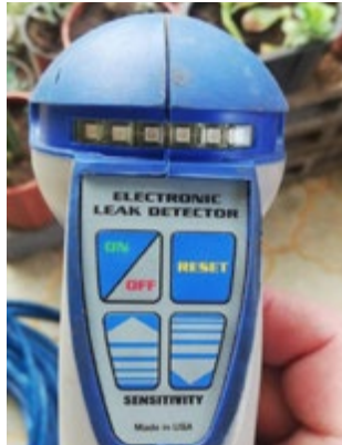
Foto 4. Detector de fugas Mastercool, modelo: 55100. ©Glenn Hidalgo Mora (HIMO), 2020
