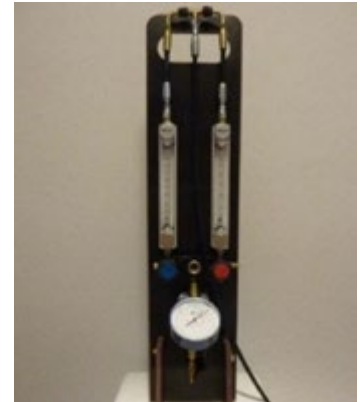
Foto 5. Equipo detector de fugas, metodología GIZ. ©Rolf Hühren (HEAT/GIZ Proklima), 2016
