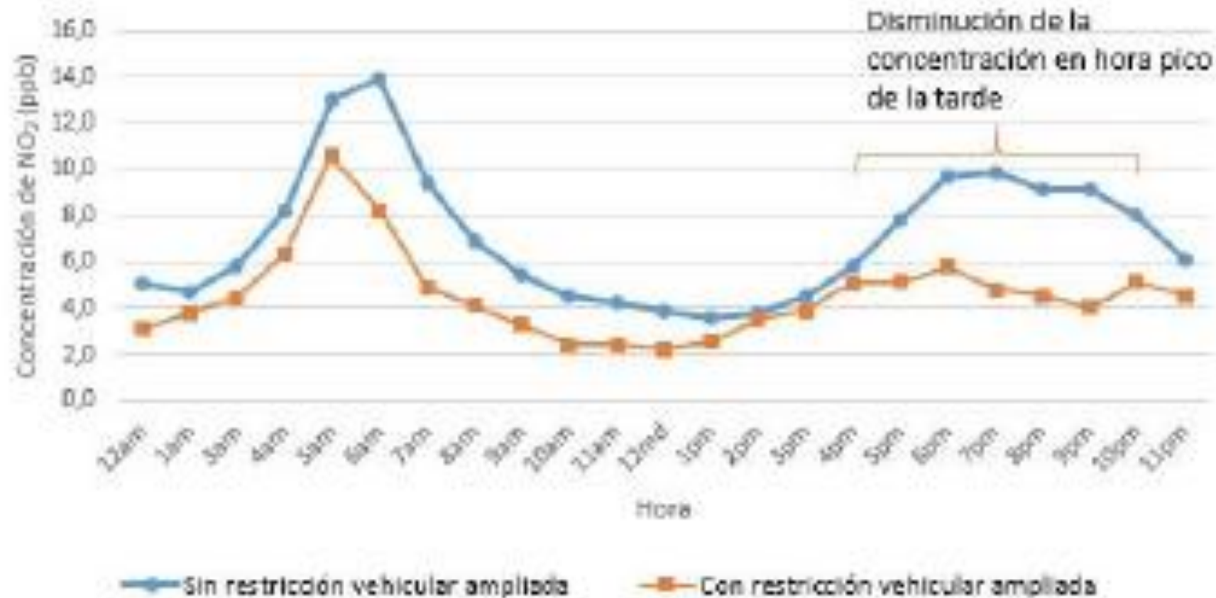
Figura 3. Variación horaria de la concentración de dióxido de nitrógeno con y sin restricción vehicular ampliada.
